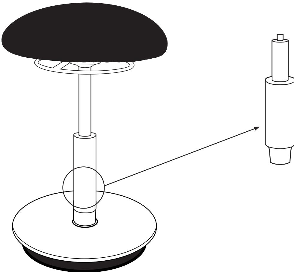
**de** Der Stuhl besteht aus einer konischen Steckverbindung, die mit einem Gummihammer bzw. herkömmlichen Hammer gelöst werden kann. (siehe Bild 1 und Bild 2)
